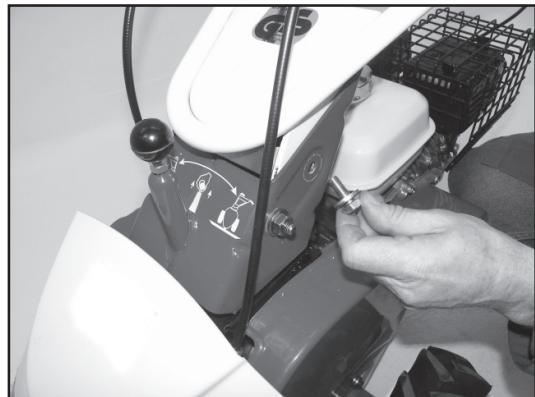
**D Schrauben und Scheiben montieren**
