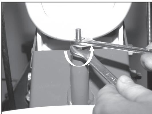
**(D) Muttern lösen und in Pfeilrichtung drehen**
