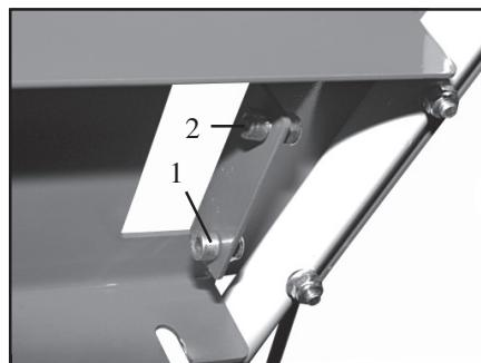
**(D) Schrauben 1 und 2 demontieren**
