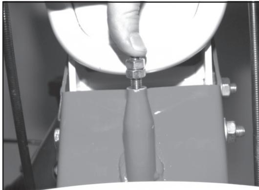
**(D) Rastbolzen festeindrücken. Schwingungs-dämpfer abgeschaltet**
