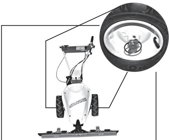
(D) Splinte in gezeigte Position = Wendehilfe eingeschaltet
