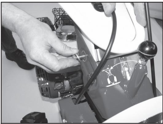
**D Schrauben und Scheiben montieren**
