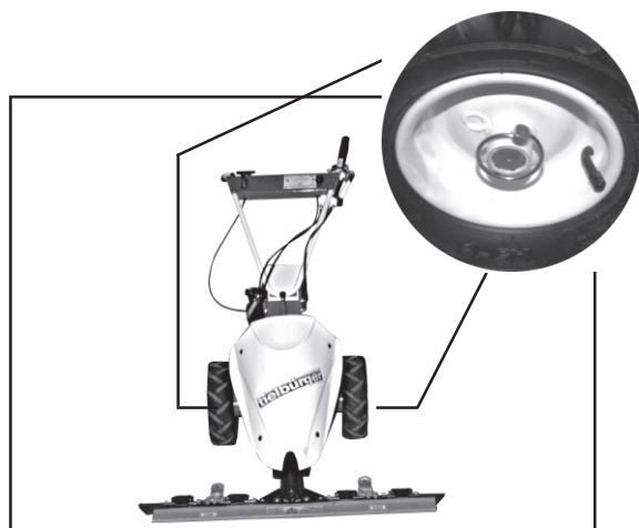
(D) Splinte in gezeigte Position = Wendehilfe ausgeschaltet
