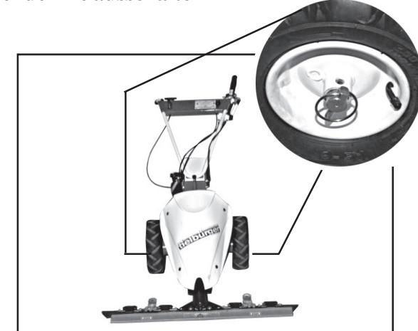
**(D) Splinte in gezeigte Position = Wendehilfe eingeschaltet**
